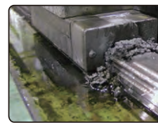
Muster nach 3.000 km Verfahrweg 3000km走行時での試験品 Test piece after travelling 3,000 km
